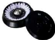
NO:5 48X1.5ml 最高转速: 12000r/min 最大离心力: 15970×g 离心管尺寸: Φ11X42mm
