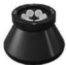
NO:7 6X10ml 最高转速:16000r/min 最大离心力:19070×g 离心管尺寸:Φ16X86mm
