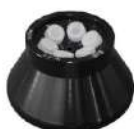
NO:8-2 6X30ml 最高转速:13000r/min 最大离心力:15620×g 离心管尺寸:Φ25.5X100mm
