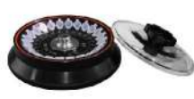
NO:3 24X1.5/2.2ml 最高转速:15000r/min 最大离心力:21630×g 离心管尺寸:Φ11X42mm
