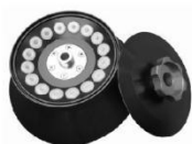
NO. 1 16x10ml Fixed-angle Rotor Max Speed : 22000rpm Max RCF : 50685xg Tube size : Φ16x86mm
